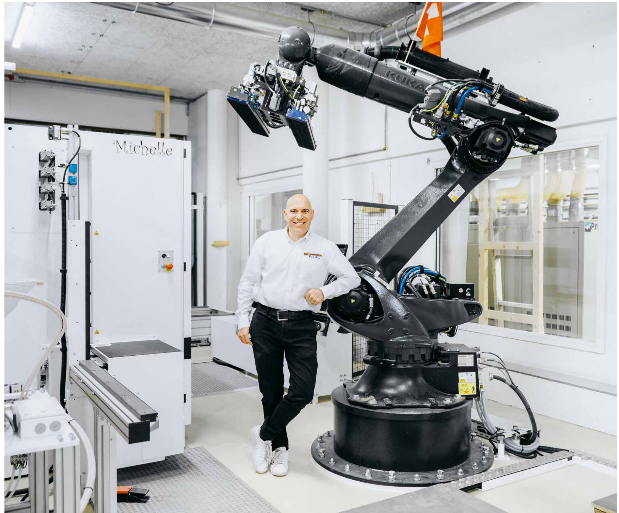
Oliver Bantli, Inhaber der Schreinerei – Holzbau Bantli AG in Eschenz TG, steht vor «Michelle», einer vertikalen CNC mit Roboterarm für Korpusteile.
