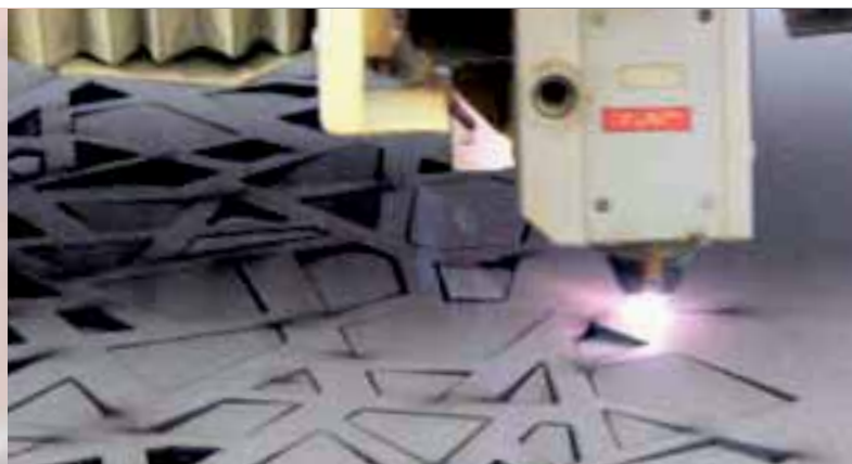
Die BRUAG AG «schneidet» ihre Werkstoffe mit Laser
